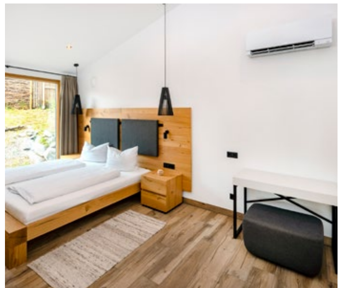
Bei den hier gewählten Multisplit-Systemen können mehrere Innengeräte an ein Außengerät angeschlossen werden. Das ist eine platzsparende Lösung zur individuellen Klimatisierung.
