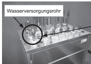
Anschluss des Wasserversorgungsrohrs
