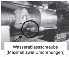
Wasserpumpe (Lage der Wasserablassschraube)
