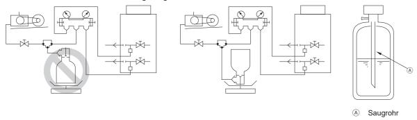
• Vergewissern Sie sich, dass die Wartungsventile nach dem Entlüften und dem Auffüllen von Kältemittel vollständig geöffnet sind. Nehmen Sie das Gerät nicht bei geschlossenen Wartungsventilen in Betrieb.
