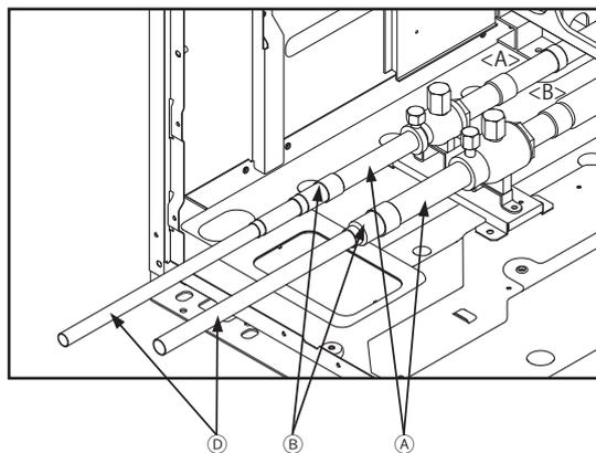
(2) Wenn die Rohrleitungen durch die Unterseite des Geräts geführt werden
