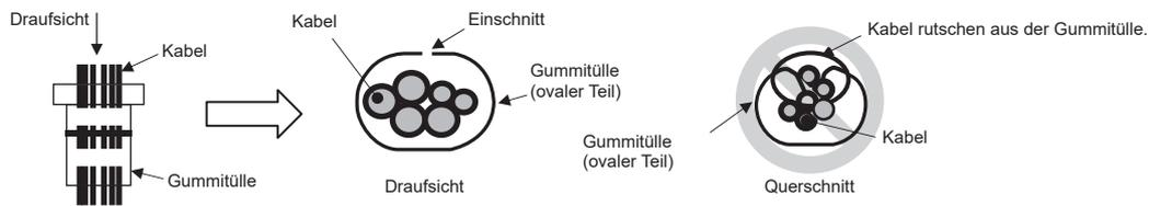
\*2 Achten Sie bei der Kabelverlegung durch die Gummitülle darauf, dass die Tülle sich nicht vom Blech am Steuerkasten löst.
