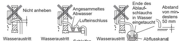
Führen Sie das Abflussrohr nicht direkt in einen Abflusskanal, in dem Ammoniak und schwefelsaure Gase entstehen können. Das sich verflüchtigende ätzende Gas kann durch das Abflussrohr zum Innenraum zurückströmen, was zu unangenehmen Gerüchen und Korrosion am Wärmetauscher führen kann.
