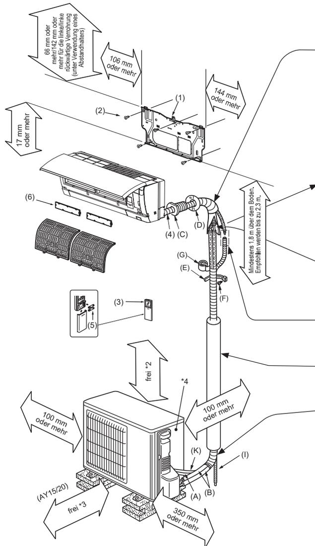
Verwenden Sie unbedingt die Wanddurchbruchhülse (C), um einen Kontakt des Innen-/Außengerät-Verbindungskabels (A) mit Metallteilen in der Wand sowie Beschädigungen durch Ratten bei Hohlwänden zu verhindern.
