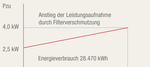
Wöchentliche Filterreinigung mittels Filterlift
