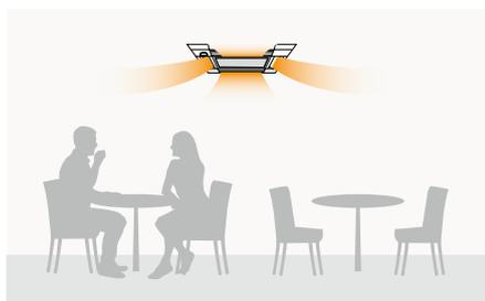
Energiesparmodus: Wenn der Raum nur zu 30% belegt ist, wird die Leistung um 1 Kelvin angepasst.
