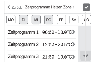
[Zeitprogramm Heizbetrieb Z1] Bearbeiten
