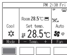
Drücken Sie [F1], um die Betriebsmodi in der Reihenfolge „Kühlen, Trocken, Lüfter, Auto und Heizen“ zu durchlaufen. Wählen Sie den gewünschten Betriebsmodus aus.
