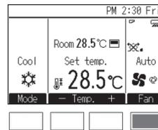
Drücken Sie [F4], um die Lüftergeschwindigkeit in folgender Reihenfolge zu durchlaufen.
