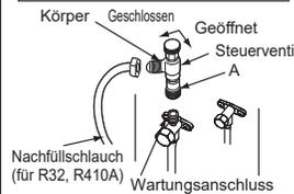
Beim Anbringen des Steuerventils an dem Wartungsanschluss kann sich der Ventileinsatz verformen oder lockern, wenn ein übermäßiger Druck ausgeübt wird. Dadurch kann ein Gasleck verursacht werden.
