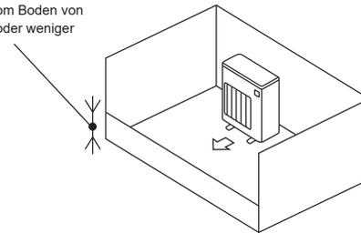
C) Für eine ausreichend große Belüftungsöffnung sorgen.
