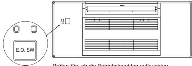
Prüfen Sie, ob die Betriebsleuchten aufleuchten. (Wenn sie nicht aufleuchten, liegt möglicherweise eine Fehlausrichtung zwischen dem Gitter und der Leuchtenposition vor.)
