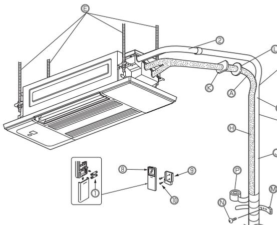
Verwenden Sie unbedingt die Wanddurchbruchhülse (K), um einen Kontakt des Innen-/Außengerät-Verbindungskabels (D) mit Metallteilen in der Wand sowie Beschädigungen durch Ratten bei Hohlwänden zu verhindern.
