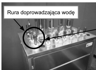
Podłączenie rury doprowadzającej wodę
