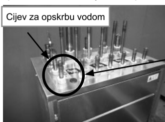
Priključivanje cijevi za opskrbu vodom
