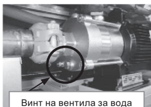
Винт на вентила за вода (Максимум два оборота)
