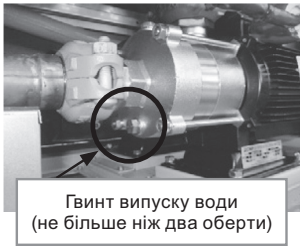
Водяний насос (положення гвинта випуску води)
