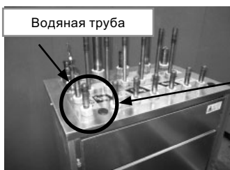
Подсоединение водяной трубы
