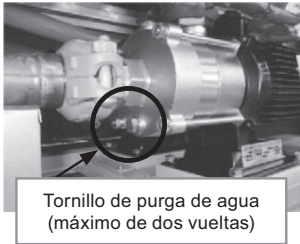
Bomba de agua (posición del tornillo de purga de agua)
