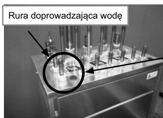
Podłączenie rury doprowadzającej wodę
