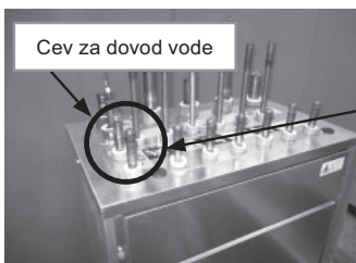
Priključivanje cevi za dovod vode
