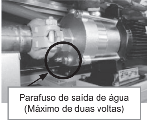
Bomba de água (posição do parafuso de saída de água)
