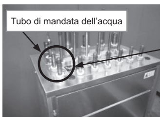
Collegamento del tubo di mandata dell'acqua
