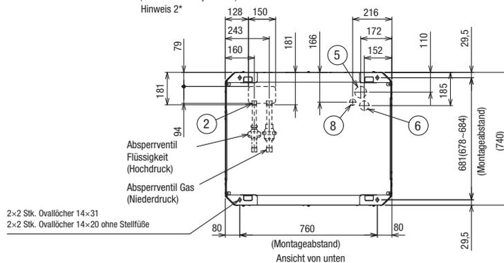
**Kältetechnische Anschlussmaße (Alle Lötanschluss)**
