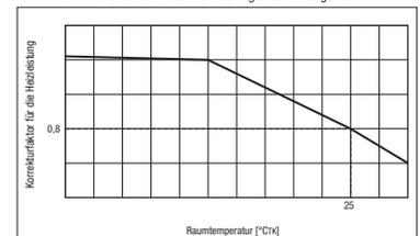
Abb. 5 Temperaturabhängige Korrektur der Außengeräte
