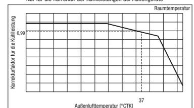
**(5) Korrektur der Nennkühlleistung des Außengerätes**
