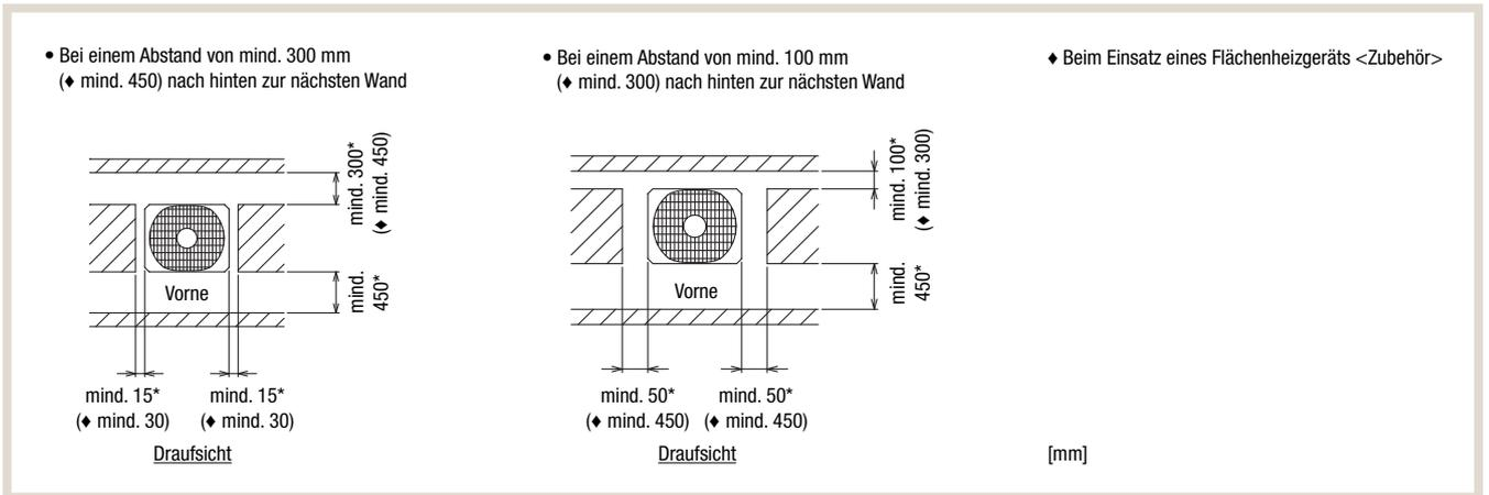
(2) Überschreiten die Wände vorne, hinten oder an den Seiten die nachfolgend beschriebenen Maximalhöhen, so müssen die Freiräume um das Gerät, die mit einem Sternchen (\*) gekennzeichnet sind, um diesen Höhenunterschied h vergrößert werden.
