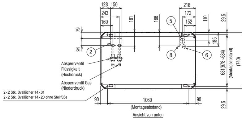
Kältetechnische Anschlussmaße (Alle Lötanschluss)
