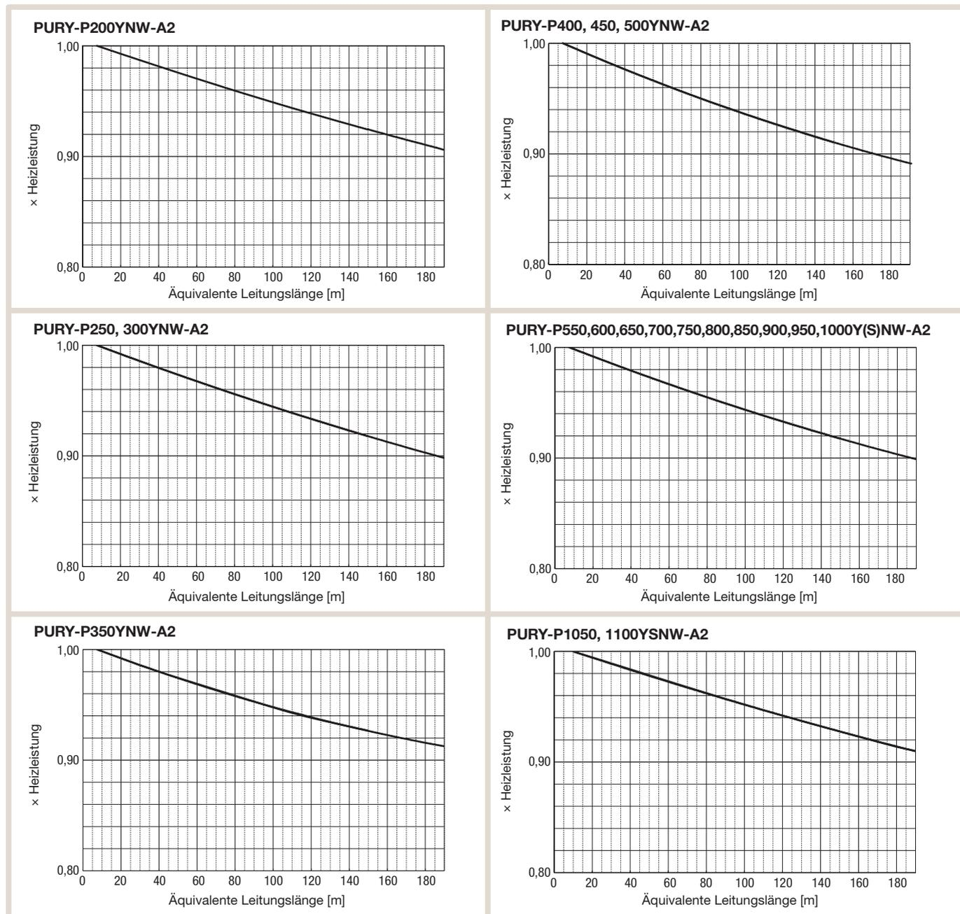
**4.4.3 Schritt 3: Berechnung der korrigierten Geräteleistung durch Multiplizieren mit dem Korrekturfaktor.**
