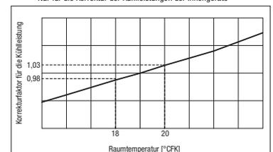
Abb. 2 Temperaturabhängige Korrektur der Außengeräte
