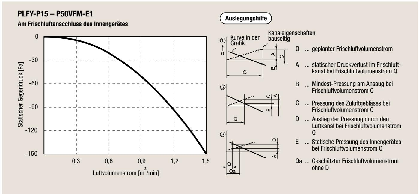
Abbildung 6.2 Auslegung des Frischluftvolumenstroms
