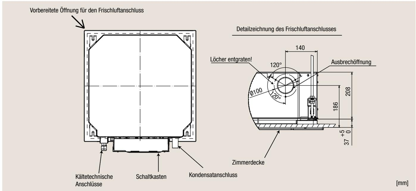
Abbildung 6.1 Möglicher Luftkanalanschluss am Innengerät
