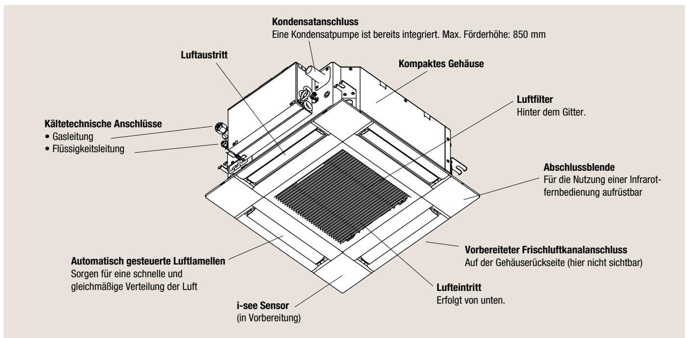
Abbildung 1.1 Anordnung der Bauteile und Bedienelemente
