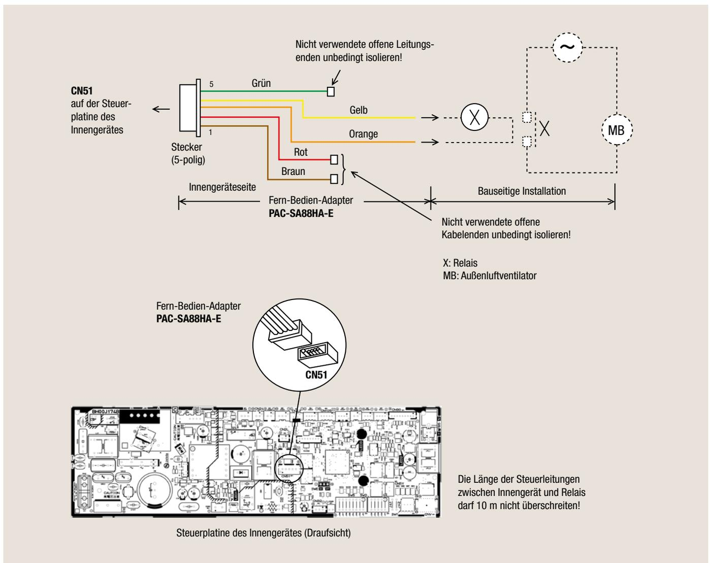
Abbildung 6.3 Verriegelter Betrieb mit einem Außenluftventilator
