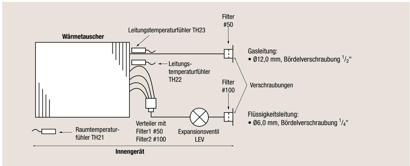
Abbildung 7.1 Kältekreislaufdiagramm
