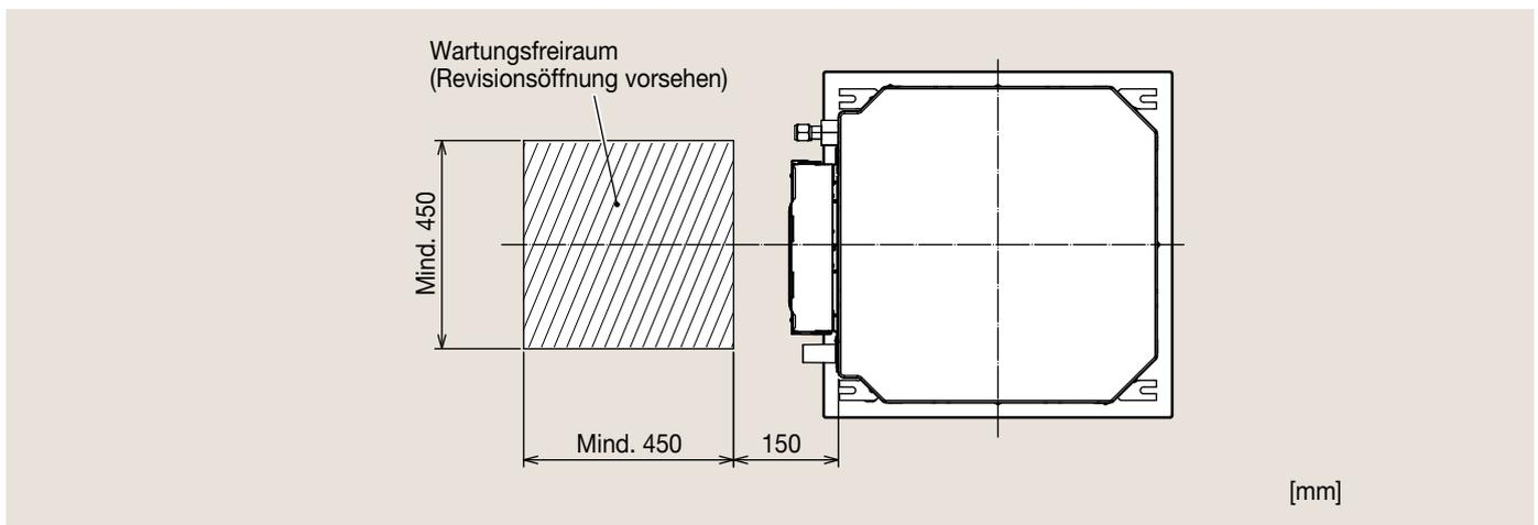
Abbildung 5.3 Erforderlicher Freiraum für Installation und Wartung
