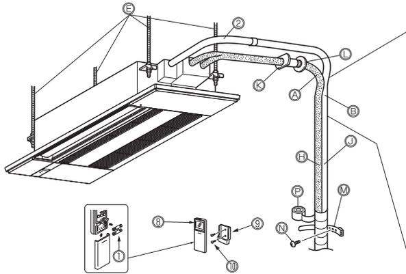
Verwenden Sie unbedingt die Wanddurchbruchhülse **Ⓚ**, um einen Kontakt des Innen-/Außengerät-Verbindungskabels **Ⓛ** mit Metallteilen in der Wand sowie Beschädigungen durch Ratten bei Hohlwänden zu verhindern.
